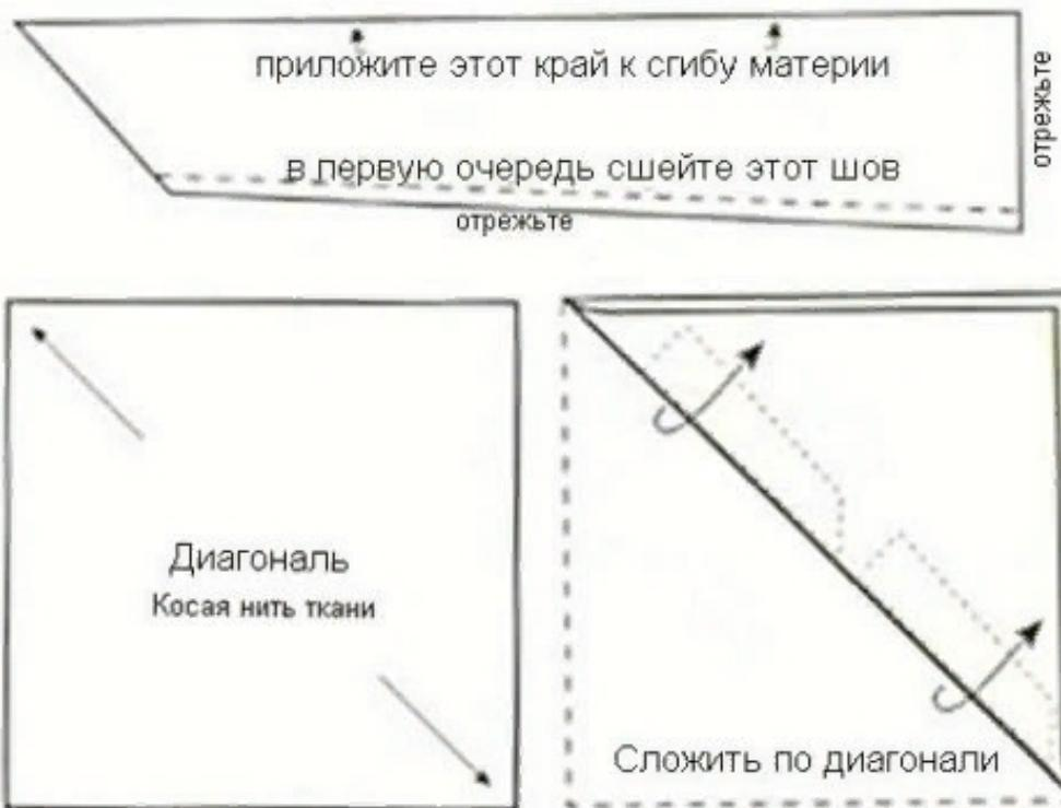
Сложить ткань пополам по диагонали (см. рисунок). Наложить две выкройки в натуральную величину на сложенную ткань. Выполнить оба шва перед тем, как вырезать перчатки. Вырезать перчатки по линиям. Завернуть верхний край перчатки внутрь примерно на 1/2" (1,25 см) для манжеты (её длина может меняться в зависимости от того, какой длины перчатки хочется сделать). Перчатки будут сидеть очень плотно.
